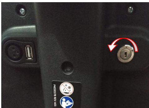
Apagado: Gire en sentido antihorario, quedando la llave en posición vertical
