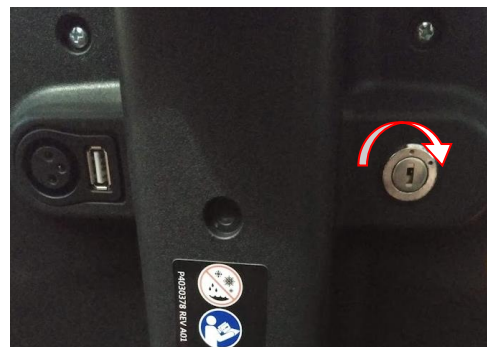
Encendido: Gire en sentido horario, quedando la llave en posición horizontal
